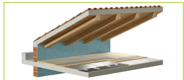
Isolamento sottofondo sottotetto
