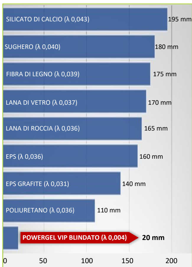
Confronto spessore materiali isolanti a parità di prestazione
