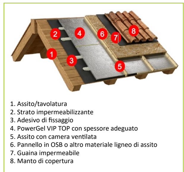
Esempio di isolamento termico copertura
